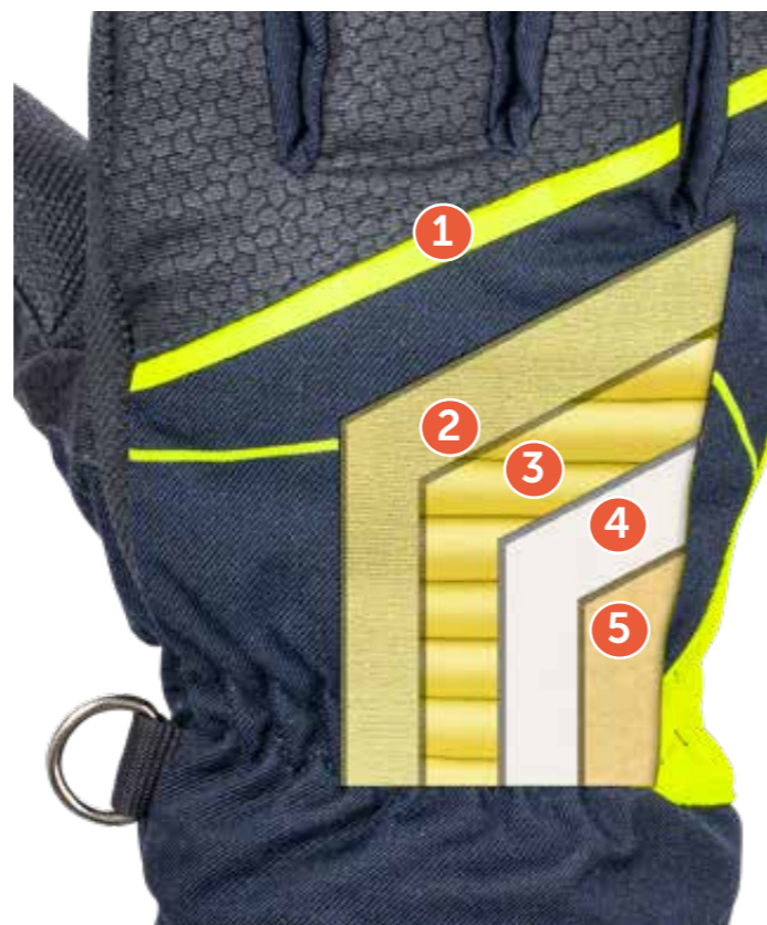
1. Aramid – svrchní látky / 2. Aramid textilní materiál / 3. PORON® XRD™ / 4. Membrána Porelle® PU / 5. Aramidová podšívka
